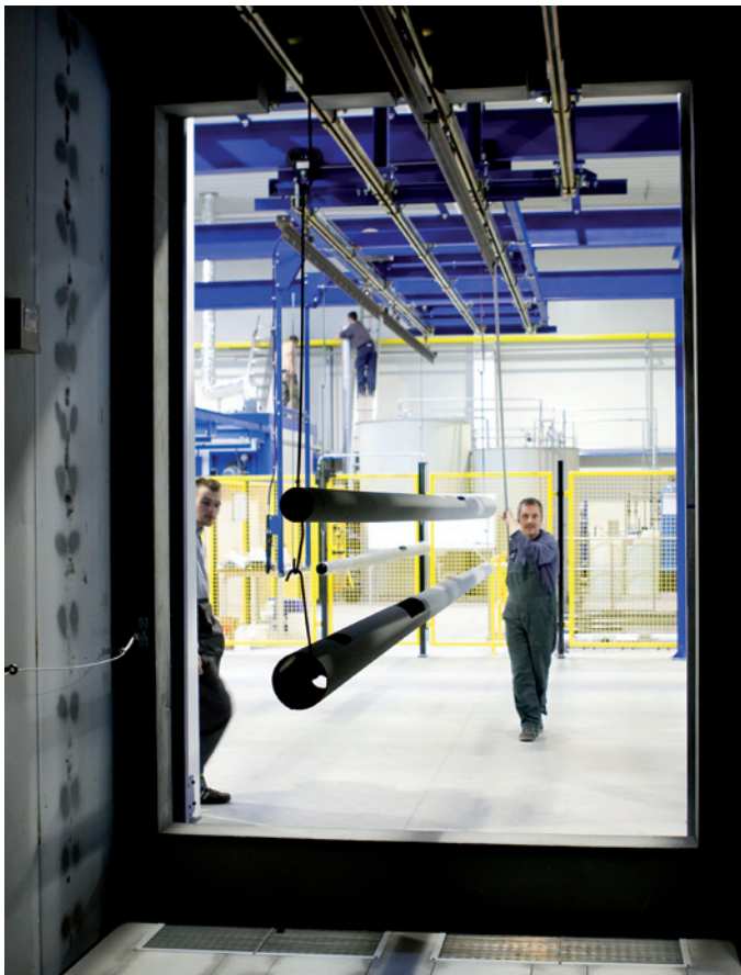
Eingang in den Haftwassertrockner.
