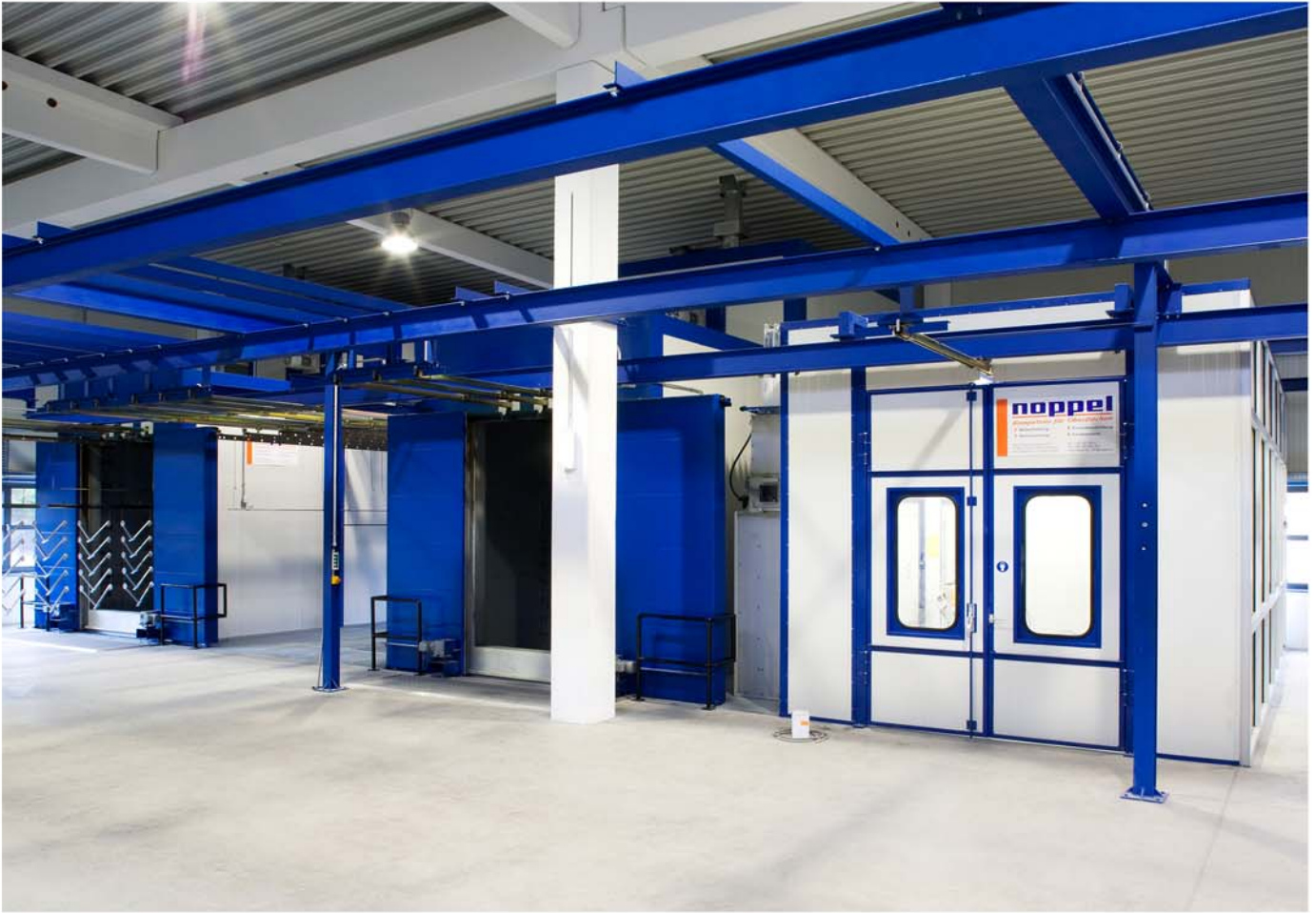
Bild oben: Pulverbereich mit Trockner, Abkühlpuffer, Pulverofen und Pulverkabine
