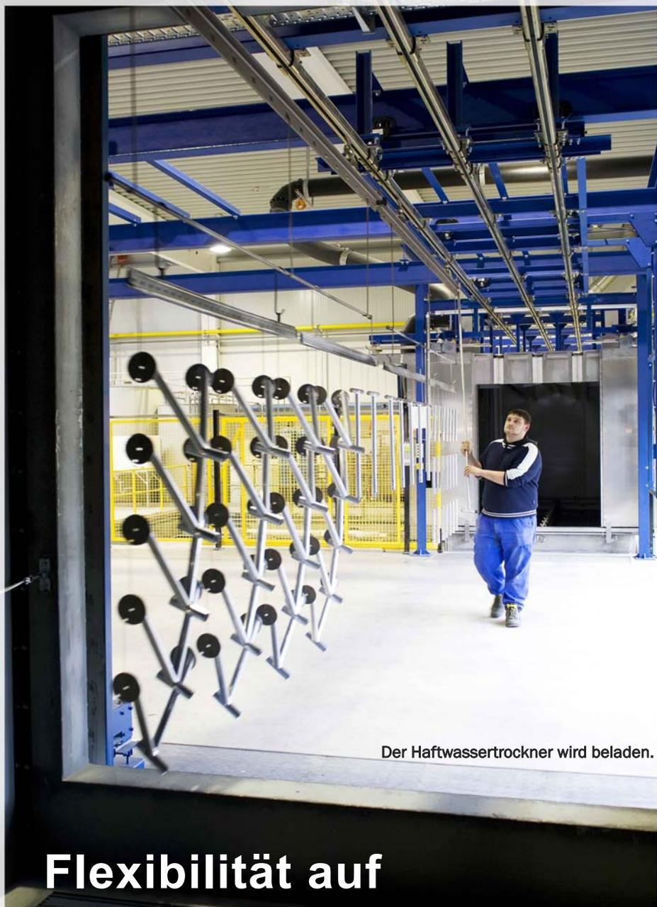
Der Haftwassertrockner wird beladen.
