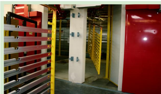
Ein- und Auslauf der Anlage: Links die rohen Werkteile, rechts die fertig gepulverten Wasserwaagen. **Quelle (vier Fotos): Stabila**
