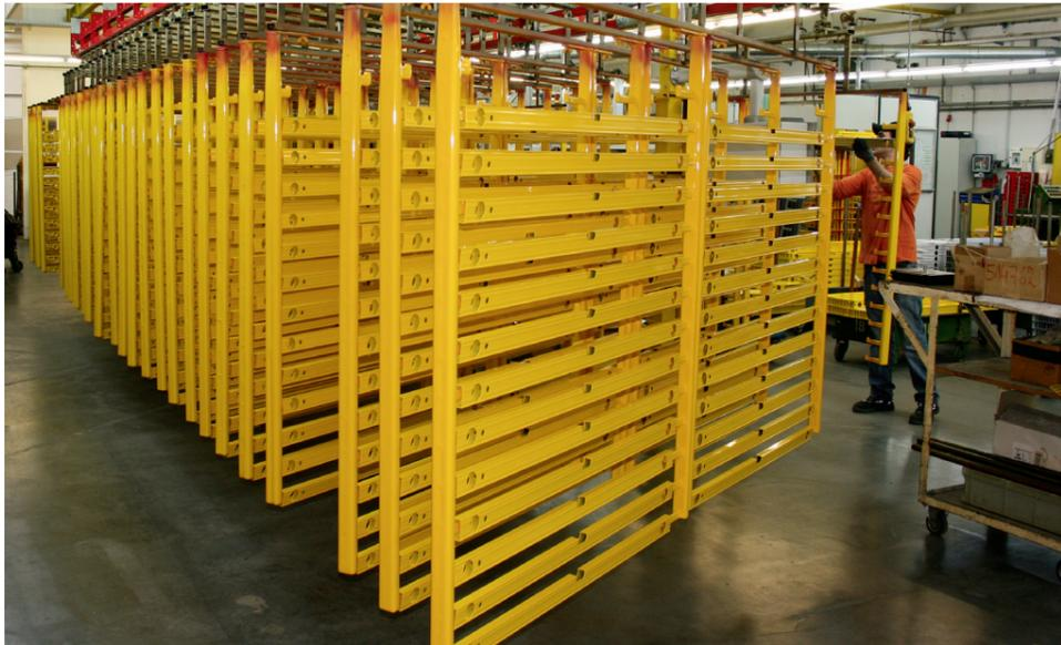
Für die Entnahme der beschichteten Wasserwaagen ist eine Pufferzone eingerichtet.
