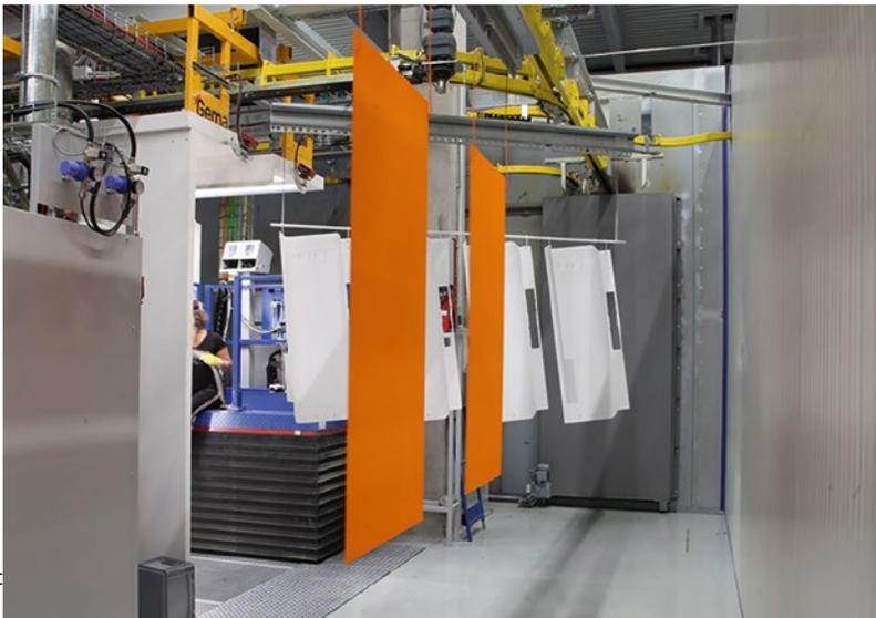
Einfahrt der Werkstücke in den Pulvereinbrennofen, der in einer Einheit mit dem Haftwassertrockner zusammengefasst ist.
