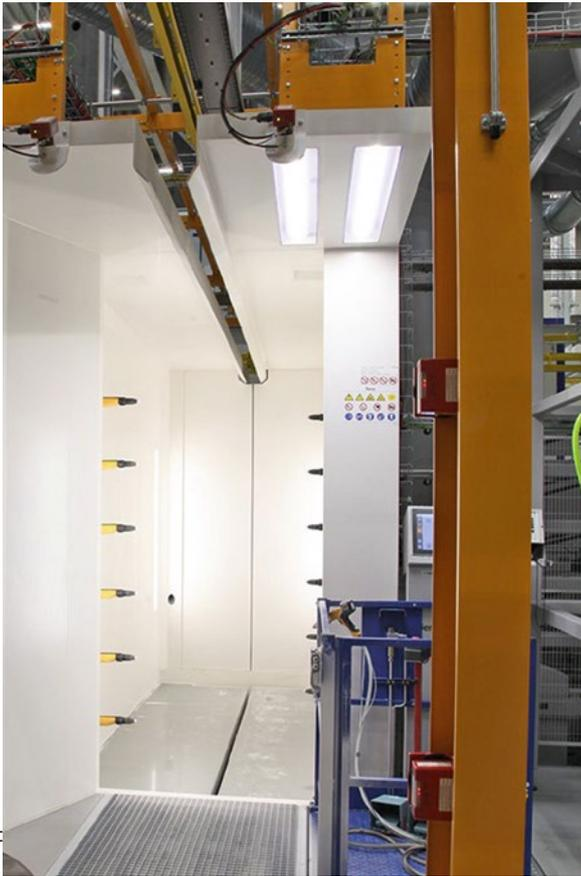
Die Automatik-Kabine ist mit einem Handbeschichter-Podest ausgestattet.
