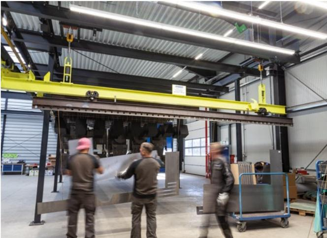
In die Auf- und Abnahmestation ist eine Hebe-/Senkeinrichtung zur Aufnahme und zum Ablegen von großen oder schweren Werkstücken vorgesehen. Auch zum Bestücken der Gehängewagen mit mehreren Reihen von kleinen Werkstück wird die Hub-Senkstation gerne verwendet, um ein rücken- und gelenkschonendes Arbeiten zu ermöglichen.
