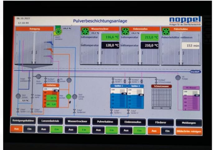
Über 85% der Werkstück können automatisch mit einer selbsttätigen verfahrenen Sprüheinheit vorbehandelt werden. Dies übertrifft die Erwartungen von S&D deutlich und führt, gemeinsam mit den beiden Trocknern/Öfen zu eine zusätzlichen möglichen Durchsatzsteigerung der Gesamtanlage.
