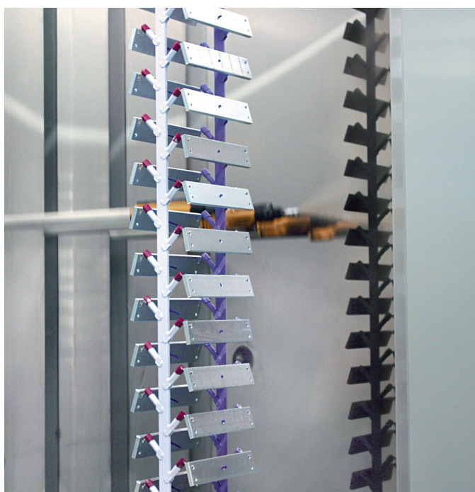
Die Pulverkabine ist mit acht elektrostatischen Automatikpistolen und einer vollautomatischen Lückenerkennung ausgestattet. Quelle: Redaktion
