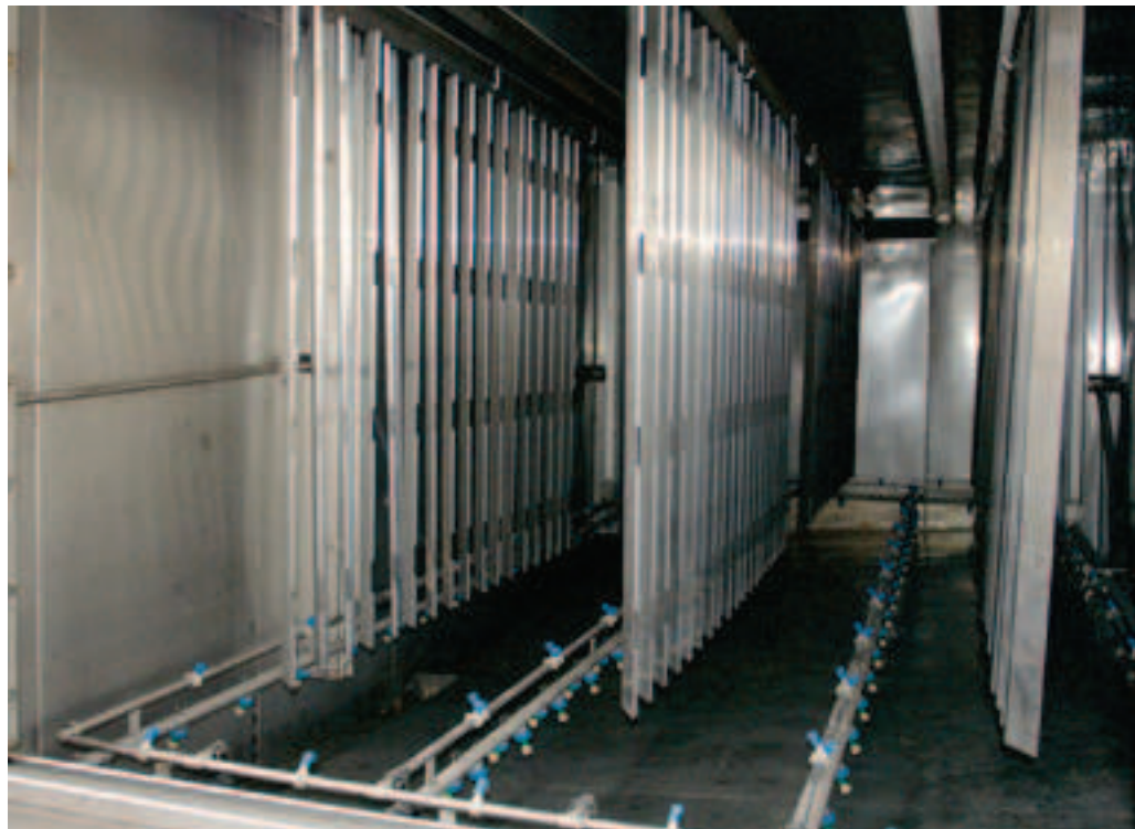
Für die Vorbehandlung werden die Medien mit einer Pumpe (links) aus den Becken gesaugt und auf die Werkstücke gesprüht. Über den Überlauf (rechts) fließen die Medien wieder zurück.
