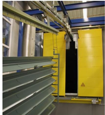
Lichtschranken-gesteuerte Schiebetüren passen die Ofenöffnungen den Teilebreiten an und reduzieren somit Wärmeverluste
