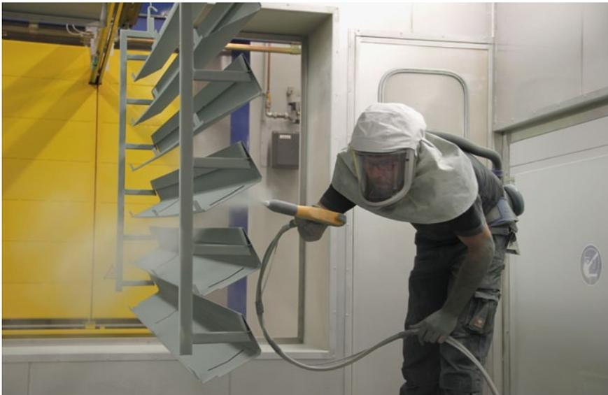
Beschichtet wird vorerst nur manuell – spätere Automatisierung nicht ausgeschlossen
