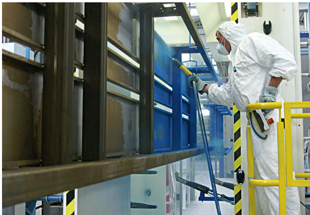
Die Pulverkabine ist im Einlauf mit einem Arbeitsplatz für die Handbeschichtung ausgestattet.
