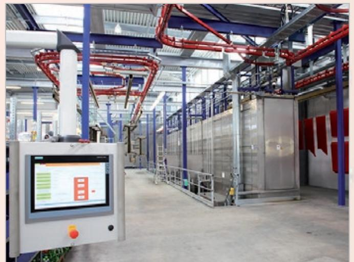
Einbrennofen und Haftwassertrockner sind hier zu einem kompakten Block zusammen gebaut. Diese Bauweise reduziert die Trockneroberfläche und dadurch die Energieverluste.
