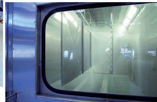
Abmessungen von sieben mal 2,7 mal 2,8 Metern werden im Nassverfahren lackiert.
