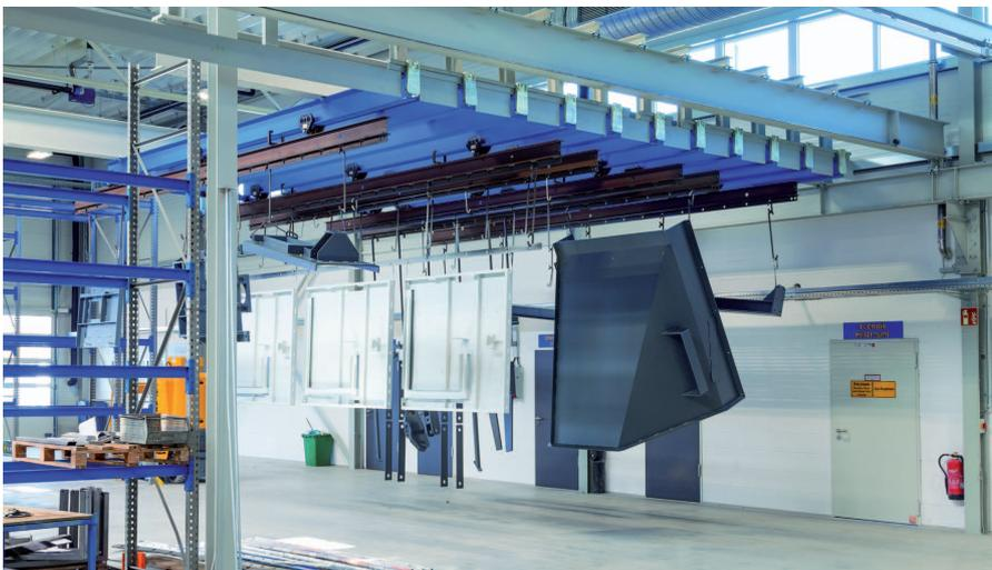
Ein effizientes Transportsystem verbindet die einzelnen Anlagenteile und erkennt über ein ausgeklügeltes System, welches Werkstück zu welchem Anlagenteil geführt werden muss.
