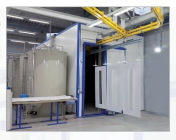
Der eigentliche Absolut-Pulverfilter wurde außerhalb der Staubschutzabtrennung angeordnet. Die Abluft kann wahlweise in die Halle oder nach außen abgeleitet werden.
