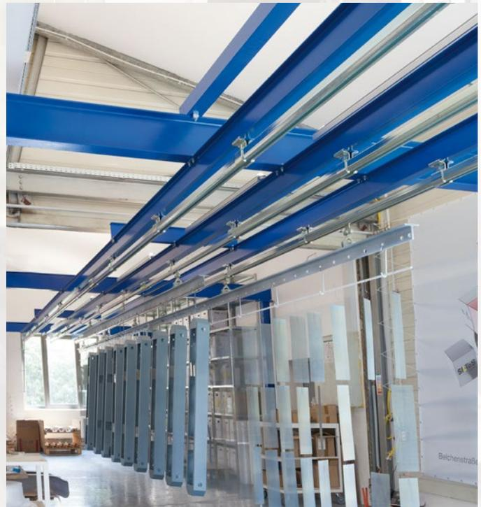
Auf- und Abnahmestation befinden sich an einem zentralen Ort. Sie wurden so platziert, dass Werkstücke auf kürzestem Weg aus den Produktionsabteilungen des Unternehmens beigestellt und wieder zurücktransportiert werden können.
