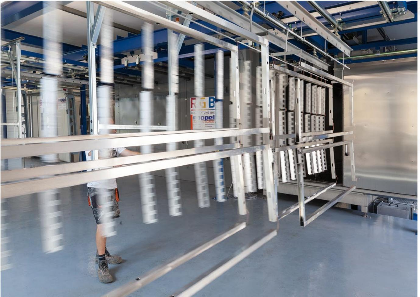
Hierfür wurden auch Pufferstrecken zwischen Einbrennofen und Pulverkabine geschaffen, die als Abkühlpuffer nach der Haftwassertrocknung oder nach dem Einbrennen der Pulverbeschichtung genutzt werden.
