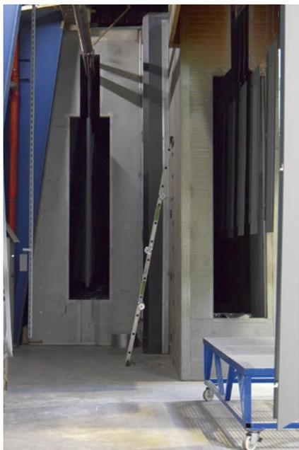
Der Pulvereinbrennofen wurde um circa neun Meter verlängert. Dadurch konnte die Verweilzeit der Werkstücke bei der Transport-Geschwindigkeit von 1,8 Metern pro Minute um 5 Minuten verlängert werden.
