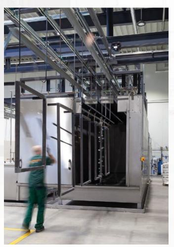
Das gesamte Fördersystem wird manuell bedient. Zahlreiche Gehängewagen erreichen die einzelnen Stationen der Anlage über die Schienenstränge mit den Verschiebewagen der Querverschiebebühne.
