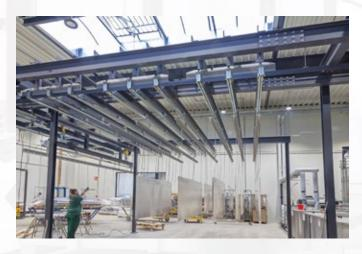
Die maximal nutzbaren Dimensionen der Gehängewagen sind mit 6.000 x 1.800 x 800 mm großzügig bemessen. Da nicht nur Teile aus eigener Fertigung beschichtet werden, sondern Drösser seine Dienste auch als Lohnunternehmen anbietet, durchlaufen unterschiedlichste Werkstück-Dimensionen die Anlage.
