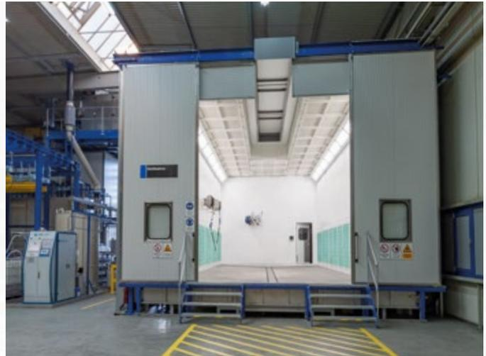
Auch in der Multikabine ist eine Zu- und Abluftanlage mit Zu- und Abluft-Filtertechnik und Wärmerückgewinnung mittels Rotationswärmetauscher / Wärmerad vorgesehen. Für die Trocknung kann die Lüftungstechnik auf Umluftbetrieb umgeschaltet werden.
