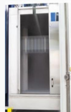
Die neue Noppel-Anlage ist mit zwei Reinigungssystemen ausgestattet. Der überwiegende Teil der Werkstücke, die bis 7.500 mm lang und 800 mm breit sind, werden automatisch in einer Reinigungskammer gereinigt und gespült. Größere Fertigungsteile reinigt STOPA manuell in einer entsprechend dimensionierten Kabine. Der Vorgang besteht, egal, ob automatisch oder manuell, aus der eigentlichen Reinigung, dem Spülschritt und dem Nachspülen/Abnebeln mit VE-Wasser.
