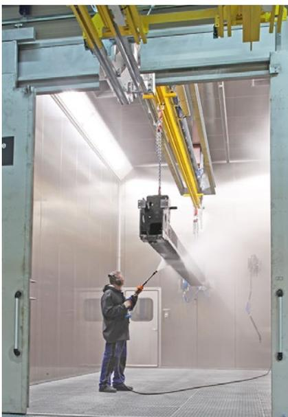
Auch bei der Reinigung hilft die Hub-/Senkeinrichtung, alle Positionen zu erreichen.
