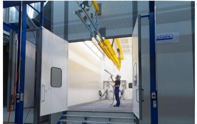
Hub-/Senkeinrichtungen stehen auch in den Lackierkabinen zur Verfügung.
