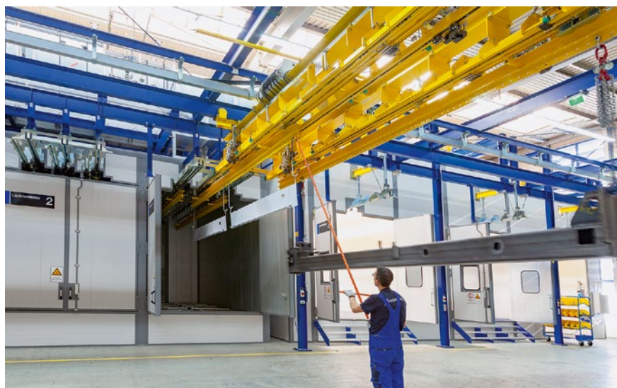
Bis zu drei Gehängewagen finden in den Trockenkabinen Platz.
