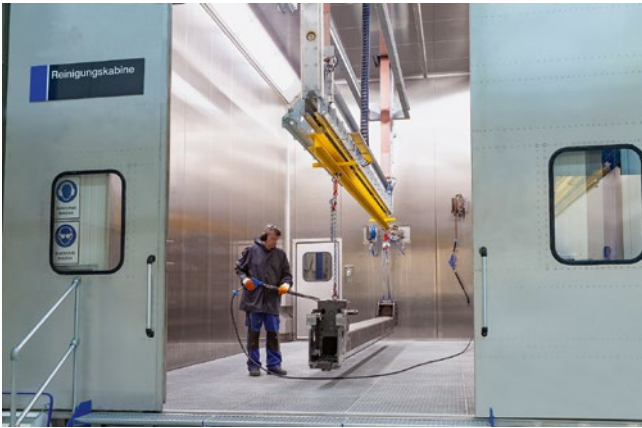
Auch bei der Reinigung hilft die Hub-Senkereinrichtung zum Erreichen aller Positionen.
