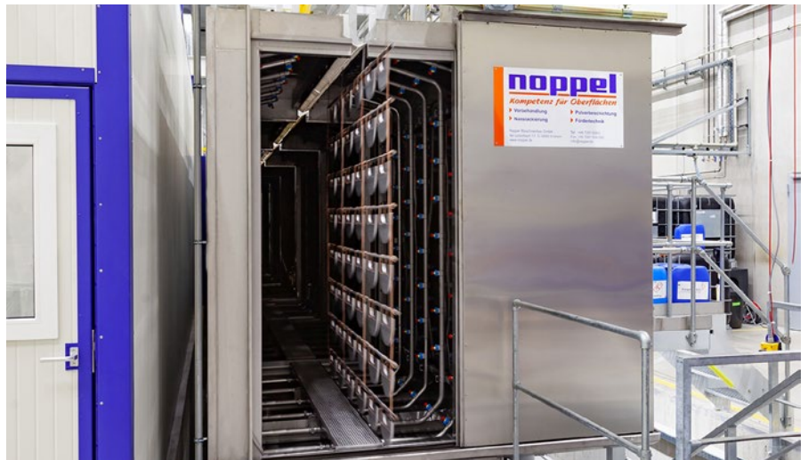
Einlauf der Multi-Material-Vorbehandlungsanlage mit sieben Kammern. Darin stehen insgesamt 15 Vorbehandlungsschritte zur Verfügung, die die Eigenschaften verschiedenster Werkstücke abdecken.
