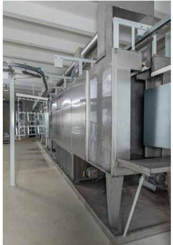
im 1. Obergeschoss einzuplanen mit einer Fördertechnik, die die getrennt angeordneten Aufgabe- und Abnahmeplätzen und die Anlagentechnik verbindet. Dadurch sollten künftig zusätzliche Arbeitsgänge und Werkstücktransporte zwischen den bis dato getrennt aufgestellten Anlagen entfallen.
