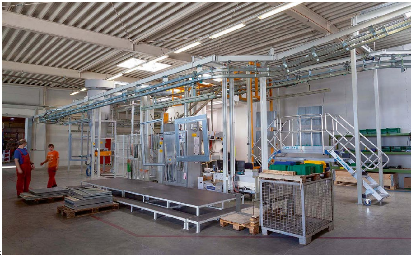
Die gesamte Anlage, bestehend aus Vorbehandlung, Fördertechnik und Pulverbeschichtung, nimmt eine Fläche von 28 x 22 m ein.
