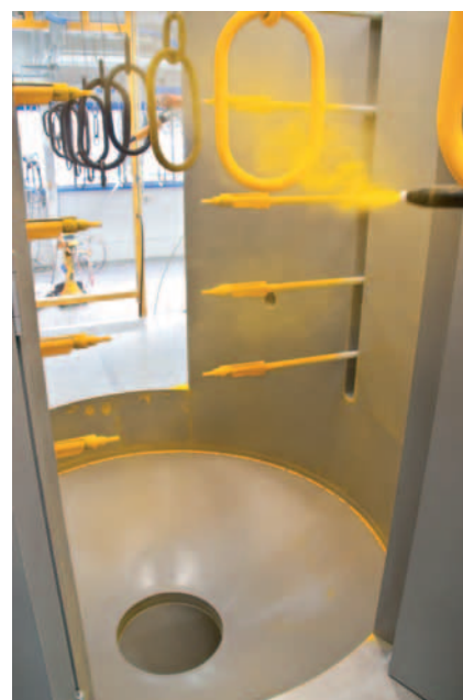
Die runde Pulverkabine von Gema reduziert laut Stefan Opfer die Farbwechseldauer von früher 40 auf aktuell 10 Minuten
